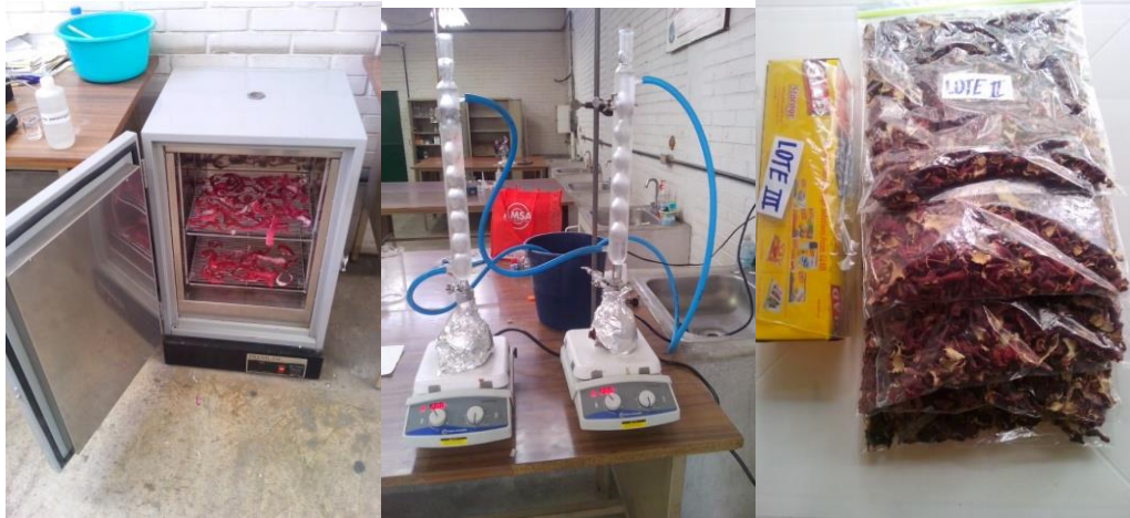
Fotografía 4-6: Secado de la materia prima y maceración dinámica a reflujo
