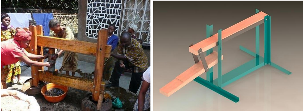
a) Proceso de compactación. b) Prensa de tecnología artesanal.
