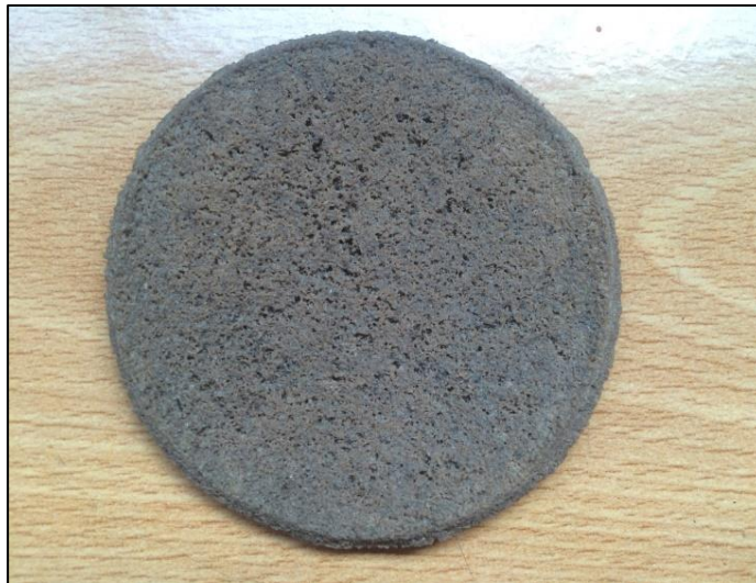
Figura 18. Membrana resultado de la sinterización
