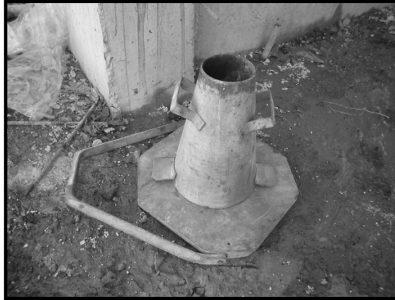
Figura 27. Molde tronco cónico con base para prueba de asentamiento
