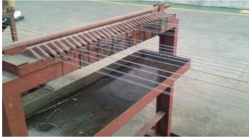
Figura 9. Piedras de drenado paso del horno de secado de flux a la cama de zinc
