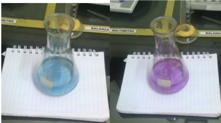
Figura 15. Titulación para encontrar la concentración del cloruro de zinc en el flux
