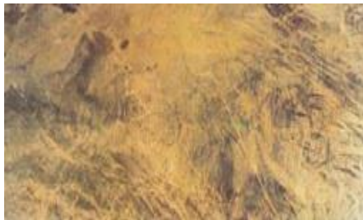
Figura 9. Apariencia con manchas de flujo
