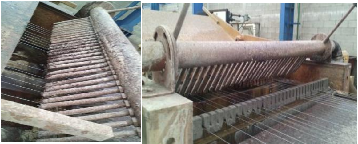
Figura 6. Sistemas de drenado por aire
