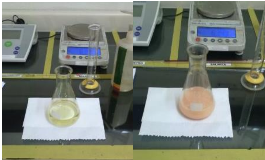
Figura 14. Titulación para encontrar concentración de cloruro de amonio en el flux
