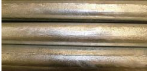
Figura 6. Acabado sin uniformidad y drenaje desigual
