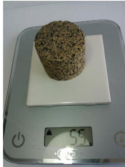
Imagen 16: peso que se obtien En el proseso de secado
