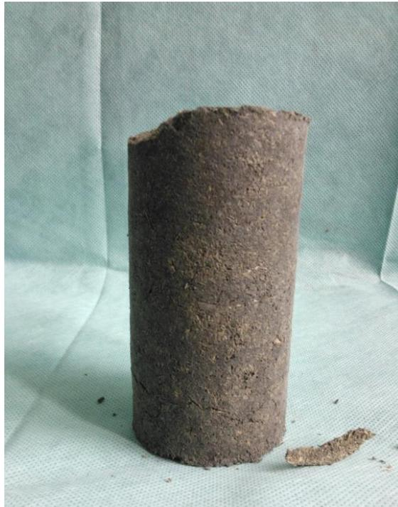
Imagen 20: Fracturas por pruebas de friabilidad
