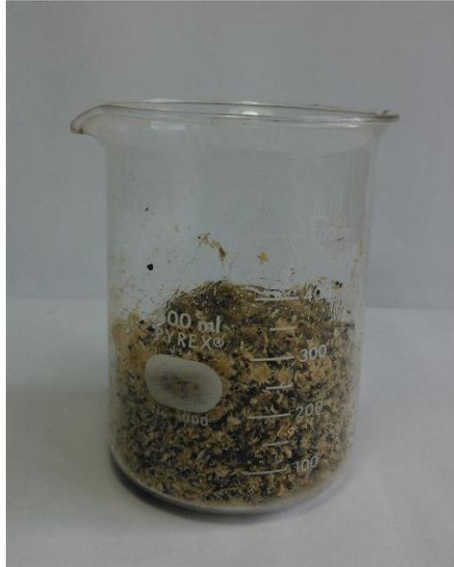
Imagen 10: mezcla de almidon de yuca, aserrin y cabon activado en el punto adecuado para poder apelmazar
