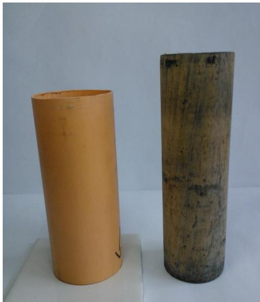
Imagen 11: utensilios para moldear y apelmazar el material
