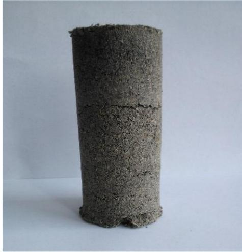
Imagen:19: Fracturas por secado
