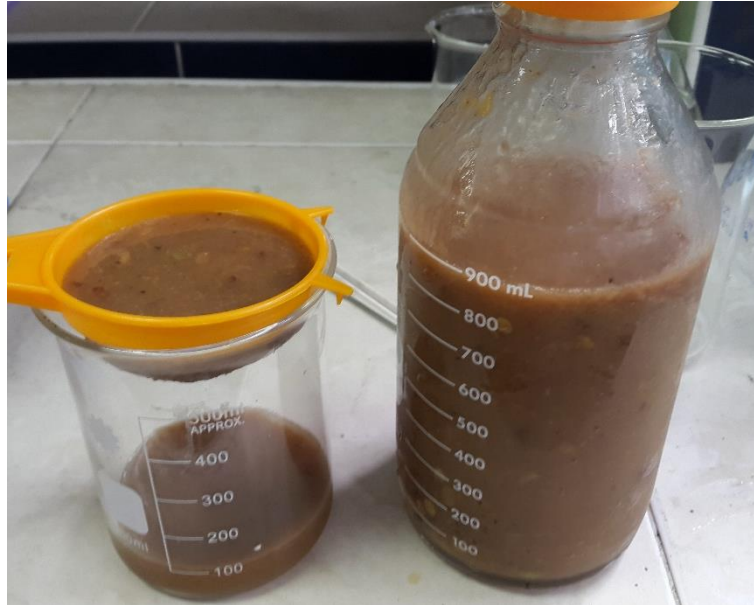
Imagen 4. Separación de sólidos gruesos
