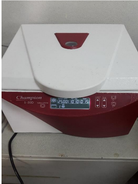
Imagen 12. Centrifugación de la pectina obtenida
