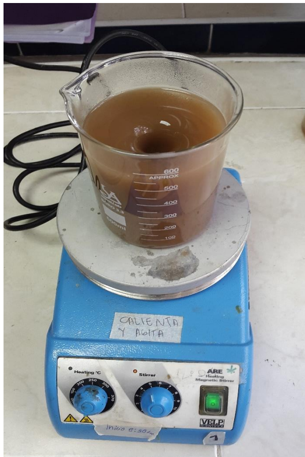
Imagen 6. Hidrólisis ácida de las muestras por el método de maceración dinámica
