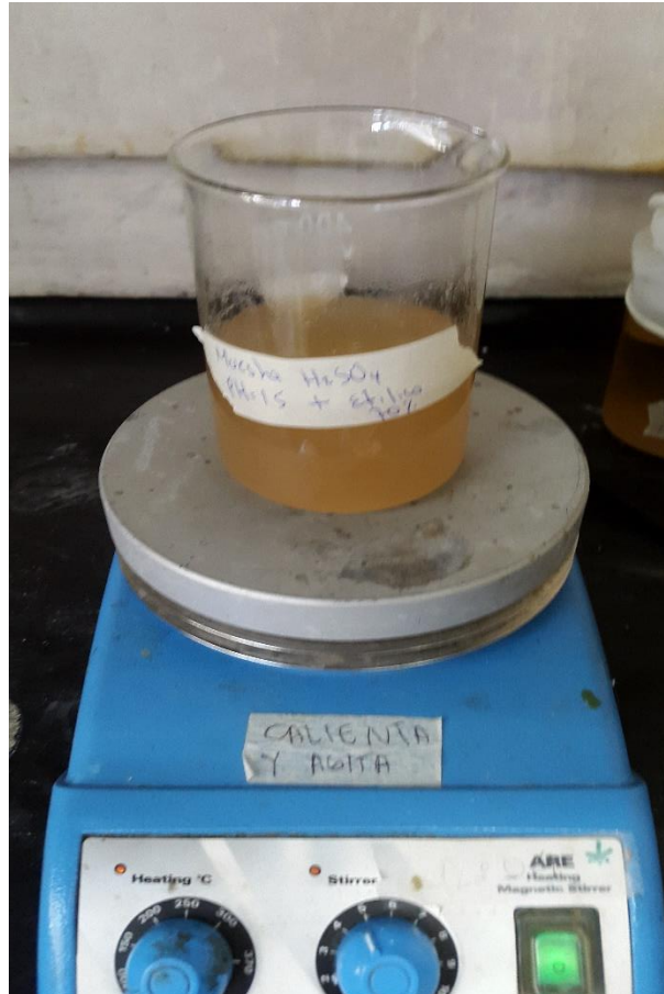
Imagen 9. Mezcla de la solución ácida con alcohol etílico al 70 % para la precipitación de la pectina
