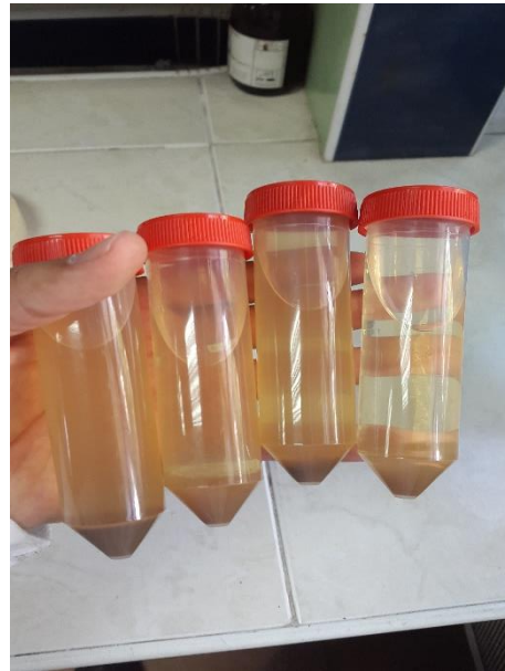
Imagen 12. Centrifugación de la pectina obtenida
