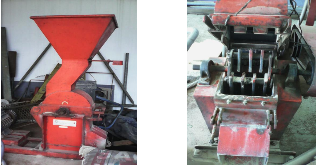
Figura 3. Molino de martillos en elevación y perfil
