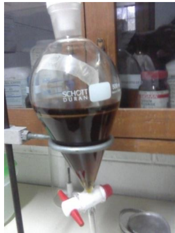
Figura 35. Primera separación mediante extracción líquido-líquido del extracto saponificado
