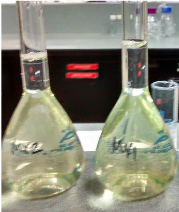
Figura 39. Preparación de muestras a evaluar como insecticida a una concentración de 1 % y 0,125 % de izquierda a derecha
