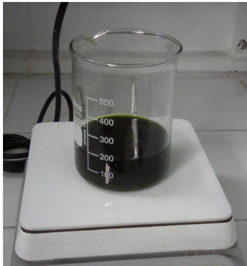
Figura 30. Maceración dinámica de hojas de quilete con etanol
