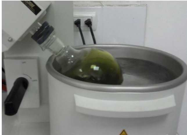
Figura 33. Concentración mediante rotaevaporación del extracto etanolico de hojas después de la filtración
