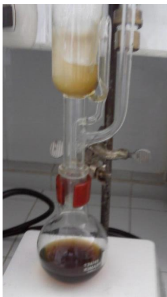
Figura 28. Tiempo óptimo de extracción de frutos de quilete utilizando etanol
