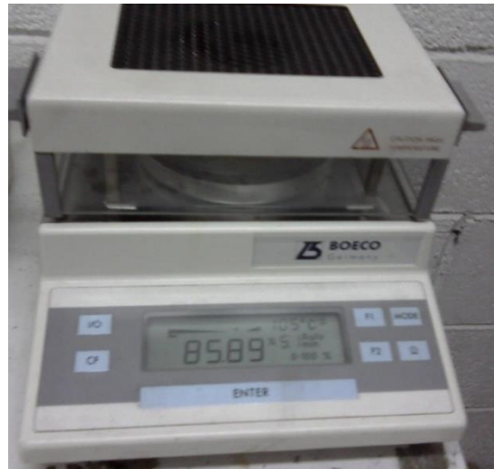
Figura 31. Determinación de contenido de solvente en extractos obtenidos mediante Soxhlet
