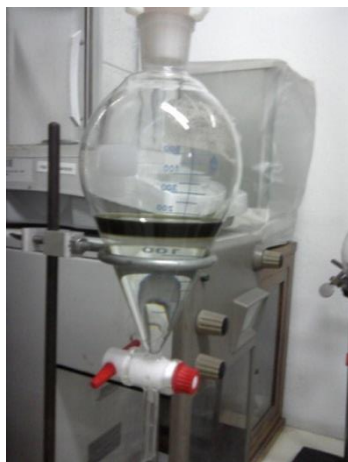
Figura 36. Extracción con cloroformo del refinado del extracto de alcaloides
