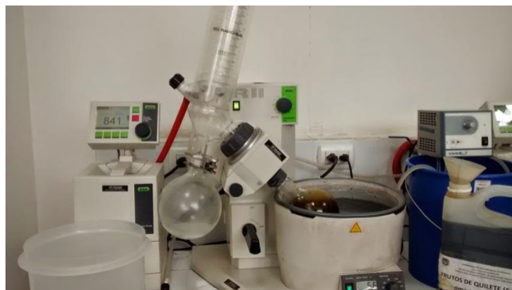
Figura 38. Concentración de extracto obtenido a escala planta piloto
