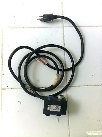
Bomba de recirculación para el sistema de refrigeración
