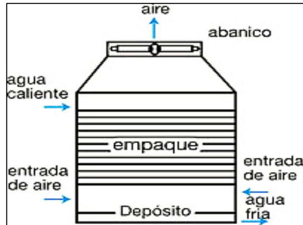
Figura 17. Torre de enfriamiento de tiro inducido
