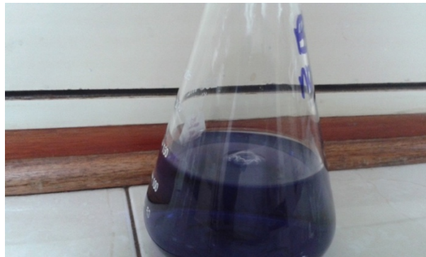
Figura 6 Punto final de titulación para la determinación de magnesio
