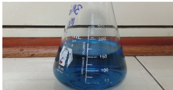
Figura 5 Determinación de magnesio por titulación con indicador negro de eriocromo T
