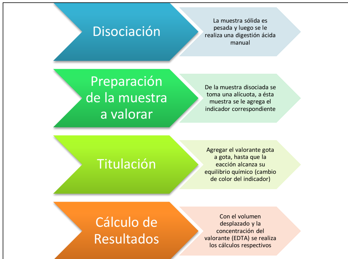
Figura No. 4 Diagrama de flujo de volumetría complejométrica
