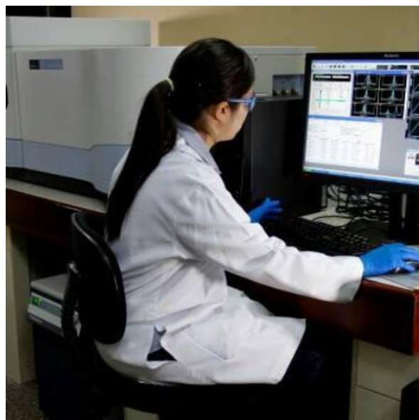
Figura 7 Determinación de calcio, magnesio y azufre por ICP-OES
