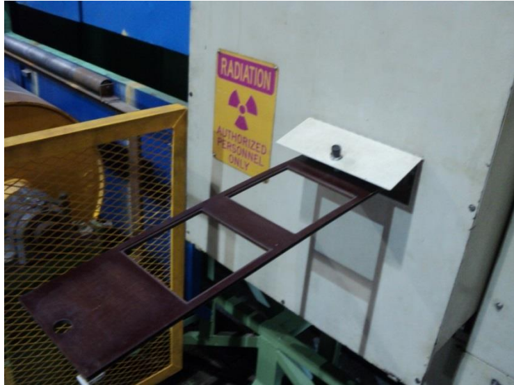
Figura 14. Introducción de una muestra aleatoria en el espacio específico en el espectrómetro
