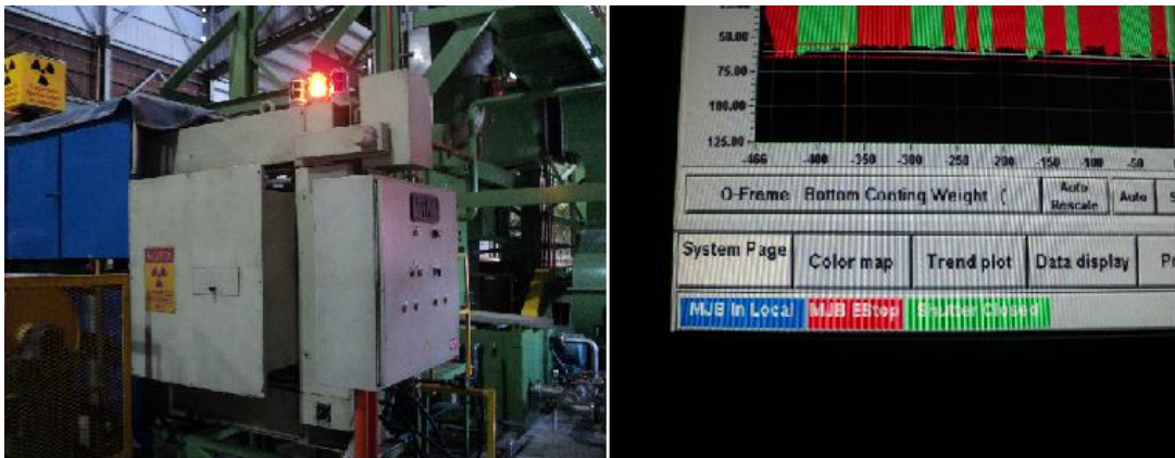
Figura 15. Proceso de lectura de los datos en el espectrómetro y en el panel de control
