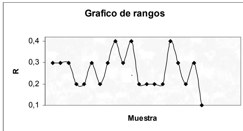
Figura 40. Gráfico de control de rangos (vaso plástico No. 7)
