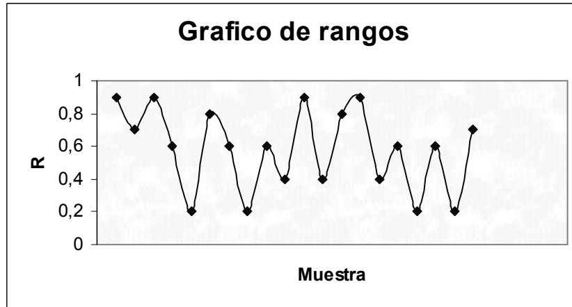
Figura 41. Gráfico de control de rangos (plato plástico No. 9)
