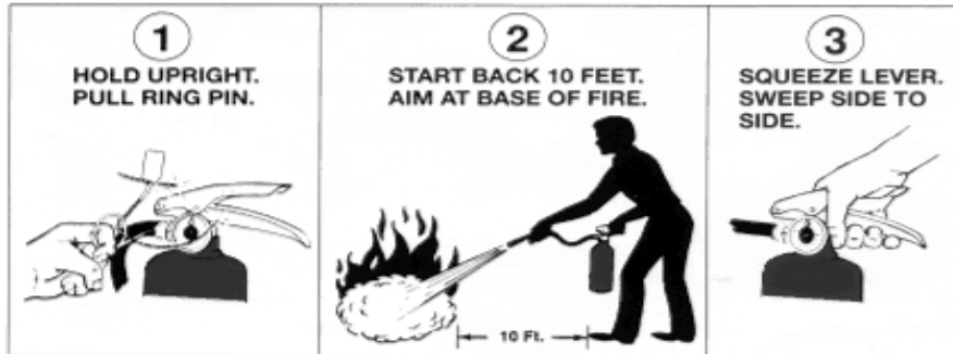
Figura 19. Instrucciones de uso de un extintor.
