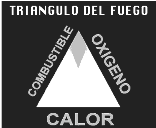
Figura 12. Elementos del triángulo del fuego.
