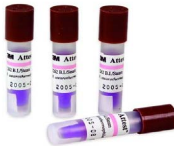
Figura 7. Indicador biológico 3M Attest / steam
