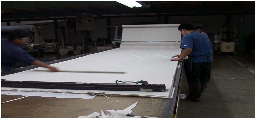
Figura 25. Proceso de Tendido
