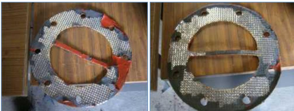
Empaque de asbesto grafitado se descompone después de humedecerse
