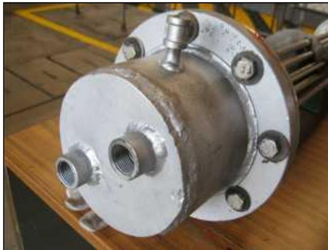
Nuevo cabezal instalado al espejo para la prueba hidrostática, pasa la prueba
