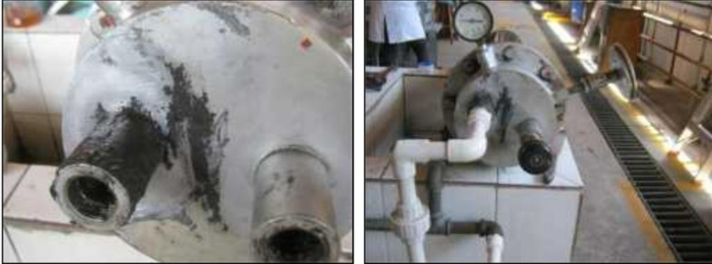
Sellado de fuga con Quicksteel (resina de epoxy) No pasa la prueba
