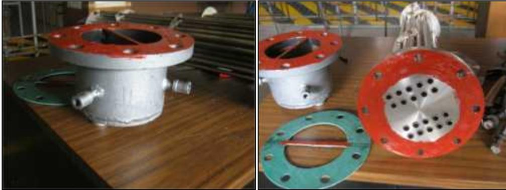
Nuevo cabezal construido para el ICCT1 con nuevo tipo de sello térmico (fibra de asbestos comprimido vulcanizado)
