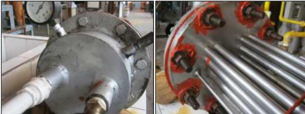
Cabezal del ICCT2 pasa la prueba hidrostática, no se observan fugas del lado del cabezal y de los pernos.
