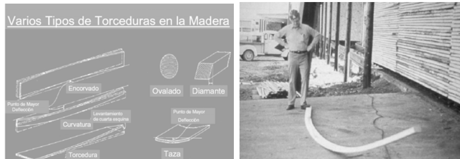
Figura 17 y 18. Defectos durante el proceso de secado
