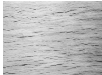
Figura 14. Defectos del secado
