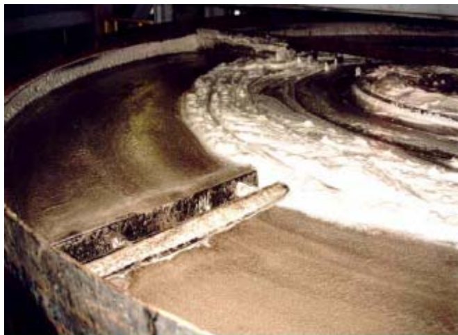
Figura 9 Clarificador Talo de floculación con retención
