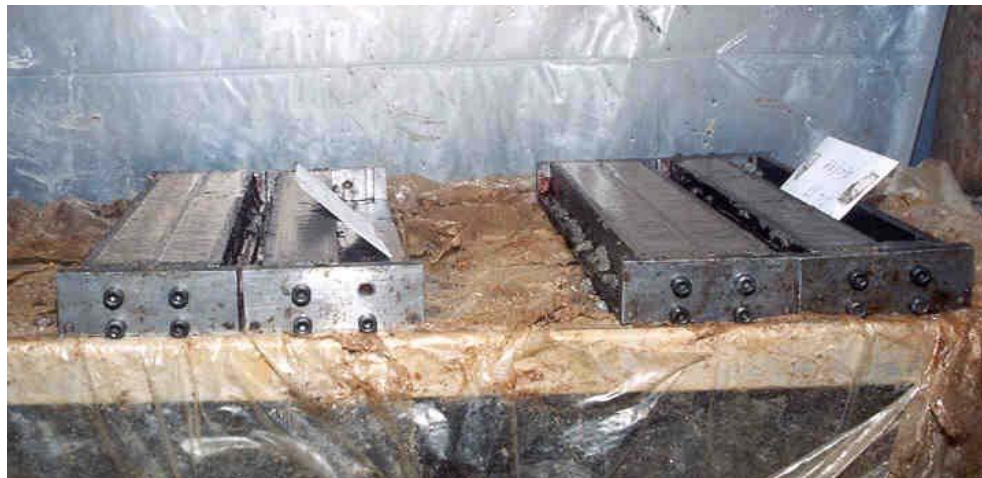
Figura 25. Barras de mortero curadas durante 24 horas en un cuarto de humedad, inmediatamente después de haber sido formadas (norma ASTM C 227)
