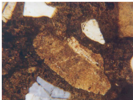
Figura 18. Una pieza de agregado (muestra el agrietamiento interno y un borde negro muy delgado alrededor de las afueras del agregado)
