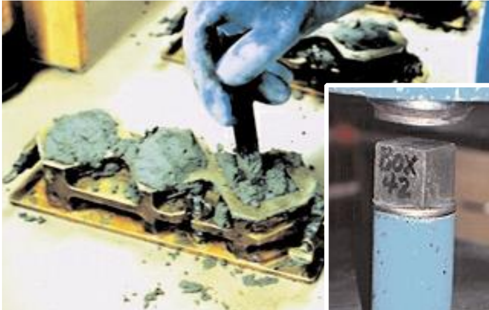
Figura 30. Fundición y aplastamiento de cubos de mortero por resistencia (norma ASTM C 109)
