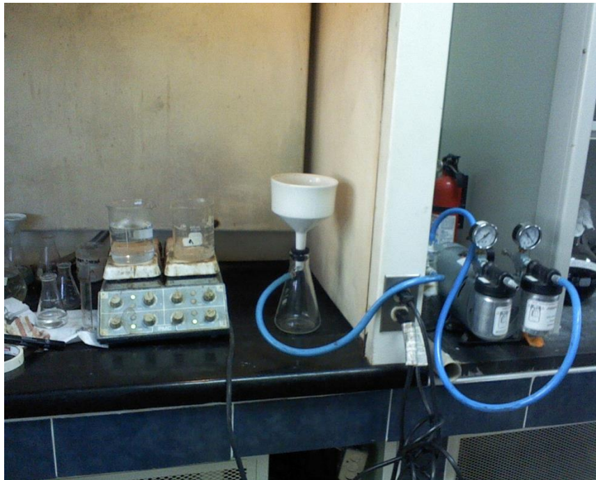
Figura 22. Ataques ácidos en campana y aparato de filtración
