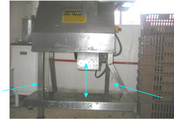
Figura 34. distancias entre tambores laterales , tolva de alimentación y recipiente recolector
