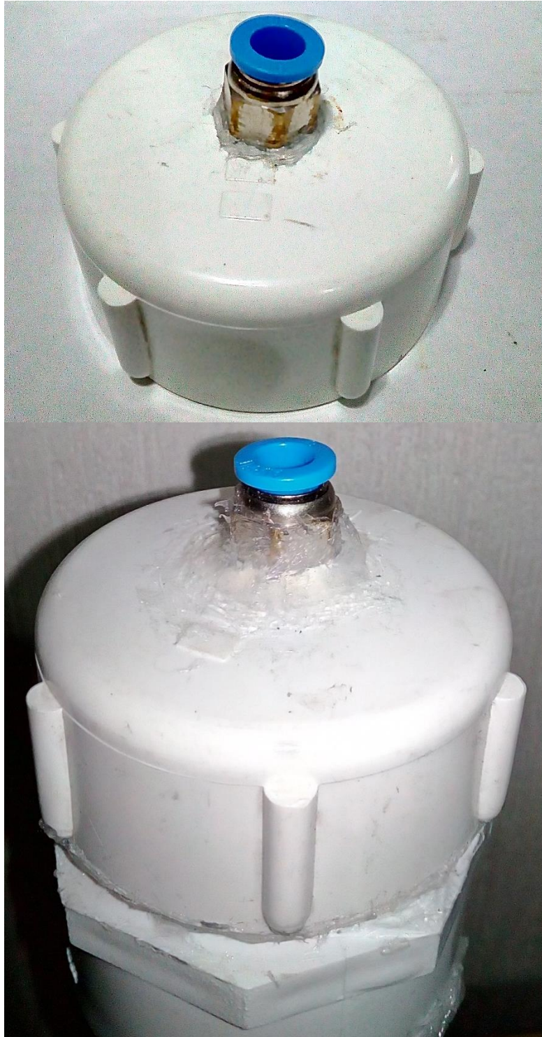
Figura 16. Tapones del reactor electrolítico
