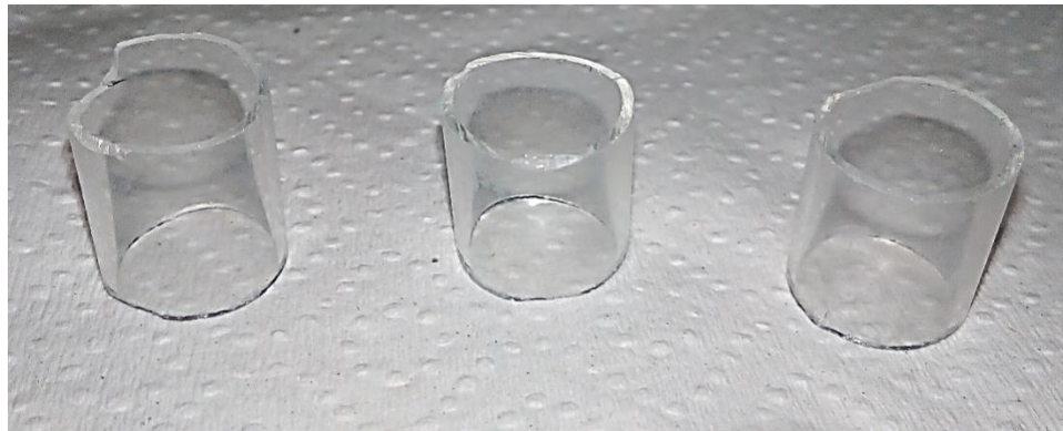
Figura 31. Empaques tipo anillos Raschig, vista frontal
