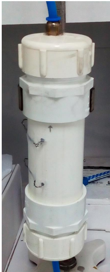
Figura 14. Reactor electrolítico continuo vista frontal
