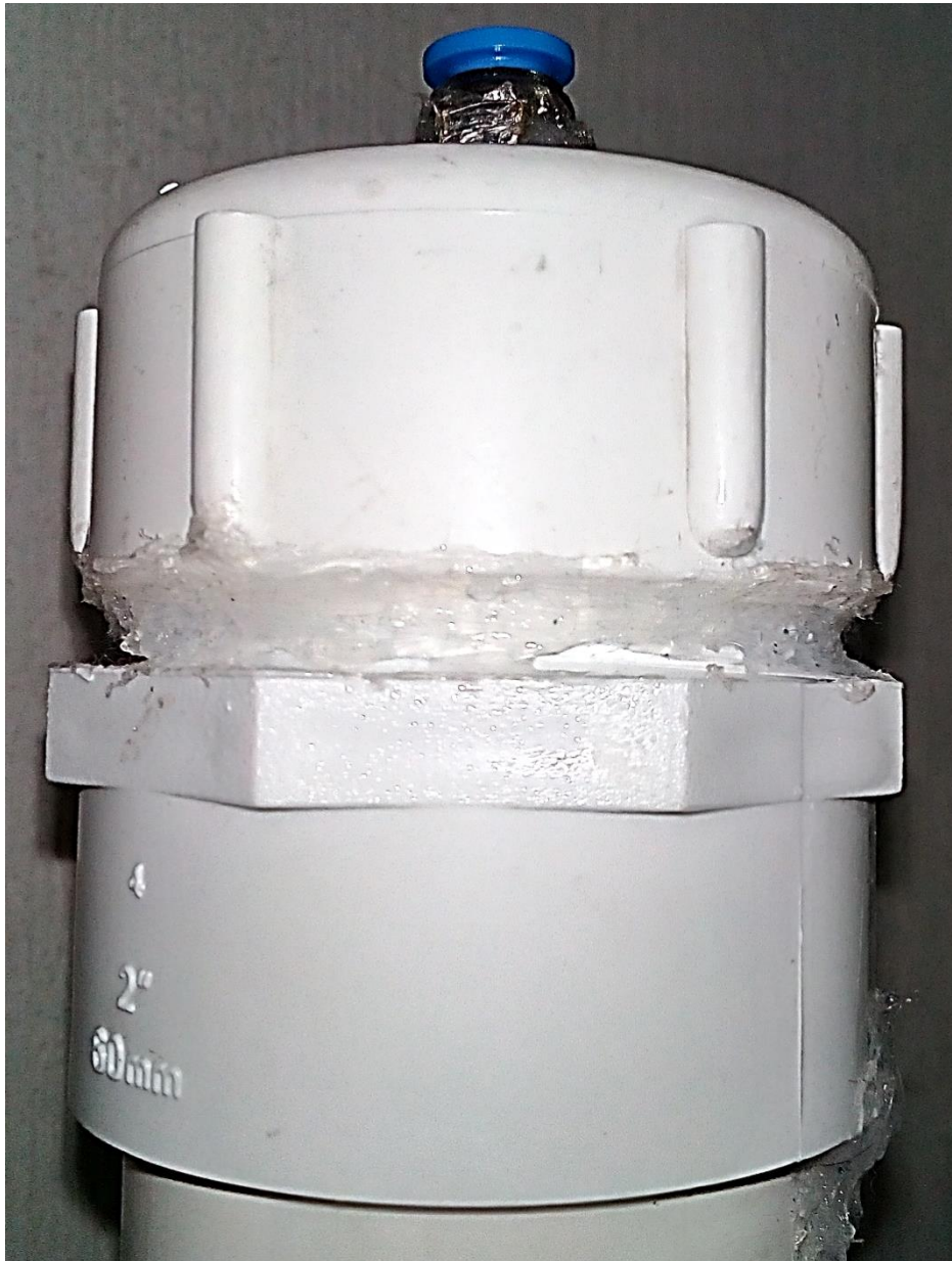
Figura 17. Acoplamiento final del tubo, adaptador, tapón del reactor electrolítico y conector de bronce a presión
