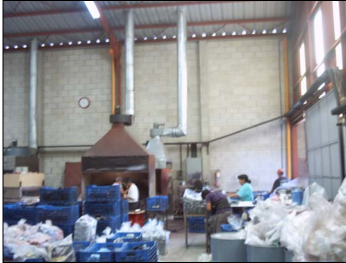
Figura 37. Falta de señalización y rutas de evacuación dentro de la planta de producción.
