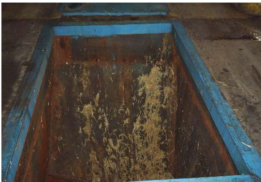
Figura 32. Tolva de separación de MP
