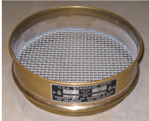
Figura 30. Estructura de malla en plato tamiz
