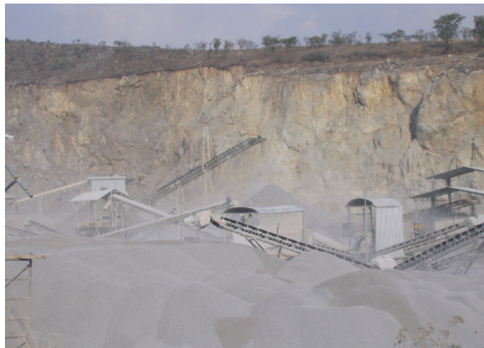
Figura 14. Transporte y separación de tamaños de agregados
