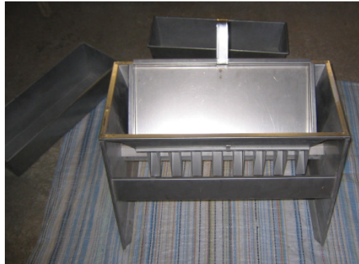
Figura 32. Aparato divisor de muestras
