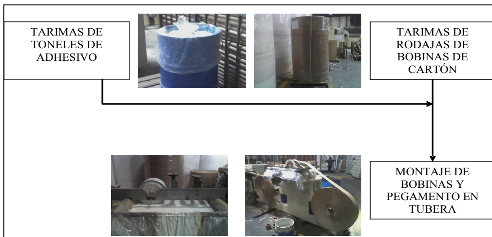
Figura 26. Esquema del pegamento
