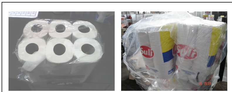
Figura 10. Productos de rechazo; Paquetes higiénicos rechazados por mal sellado de empaque
