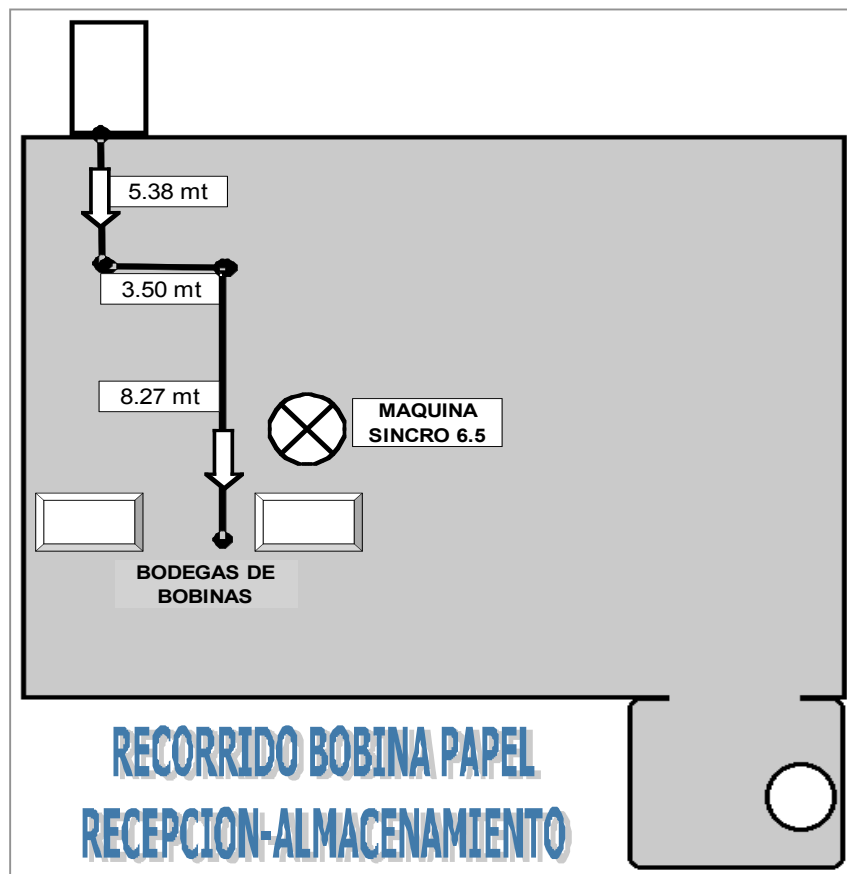
Figura 30. Traslado de bobinas de papel: recorrido dentro de la planta, mediciones en metros.
