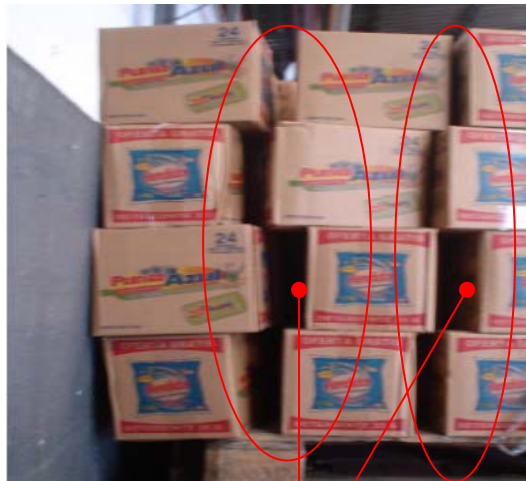
Figura 8. Estiba incorrecta, separación columnar
