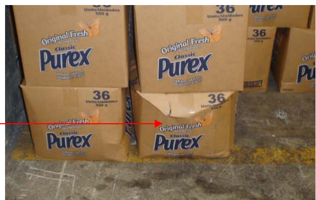
Figura 6. Caja dañada por estiba incorrecta (exceso de peso)
