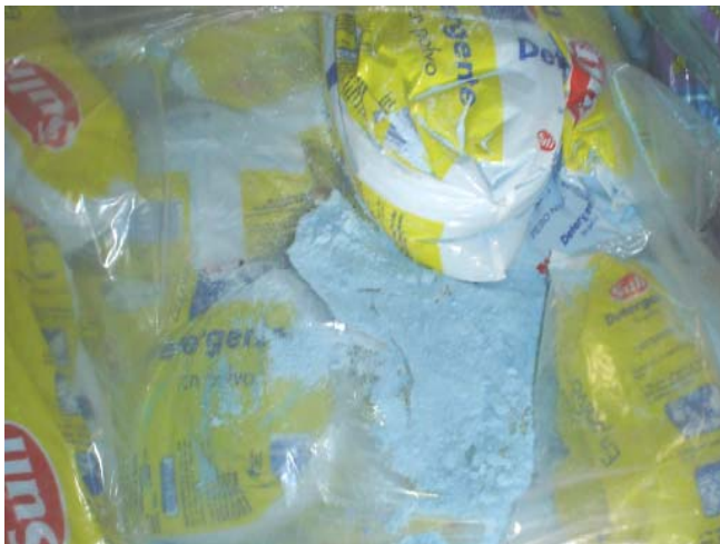
Figura 4. Empaque roto a consecuencia de una caída
