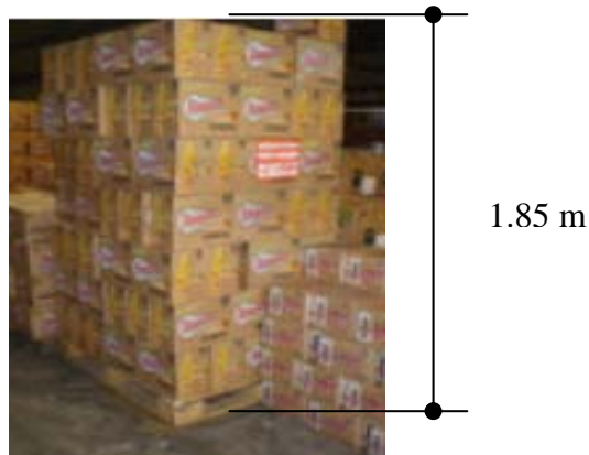
Figura 7. Estiba incorrecta exceso de altura
