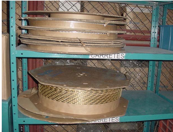
Figura 8. Carretes de terminales
