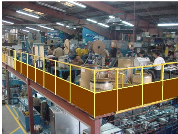
Figura 42. Barrera de seguridad en mezanine
