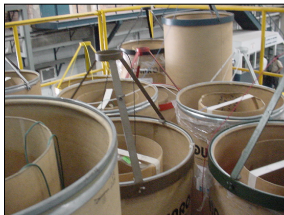
Figura 25. Conos de metal en toneles de cables
