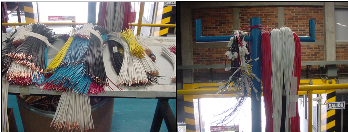
Figura 23. Carencia de dispositivo para clasificación de cables
