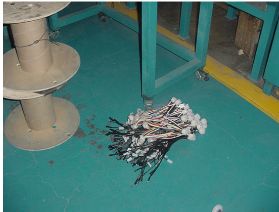
Figura 36. Incorrecta identificación de arneses no conformes
