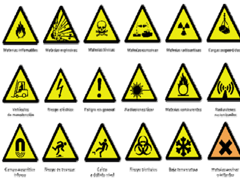
Figura 3. Señales de advertencia
