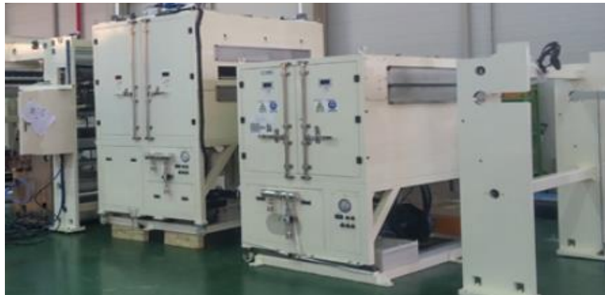
Figura 11. Horno UV de envases de aluminio
