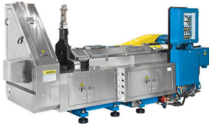
Figura 6. Formadora de cuerpo y cortadora de envases de aluminio
