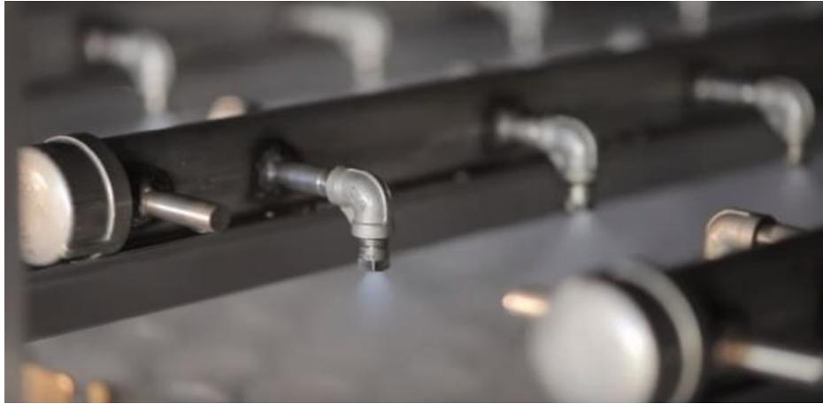
Figura 9. Aplicación de químicos dentro de la lavadora de envases
