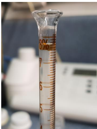
Figura 19. Determinación de grasas y aceites
