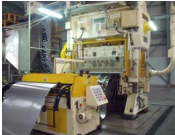
Figura 4. Troqueladora de copas de aluminio
