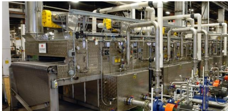
Figura 8. Lavadora de envases de aluminio
