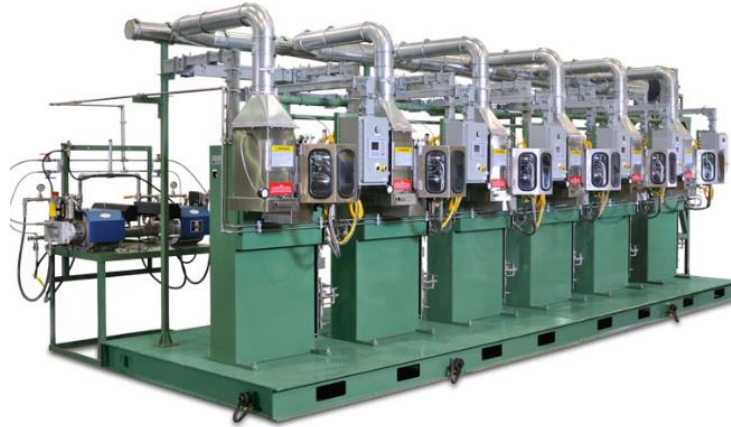
Figura 14. Espreadoras de barniz interior de envases de aluminio
