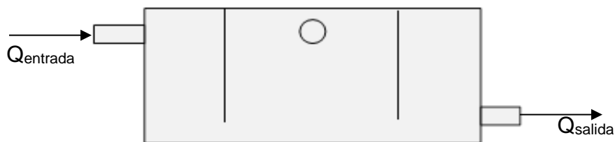
Figura 25. Vista lateral de tanque separador de grasa y aceites
