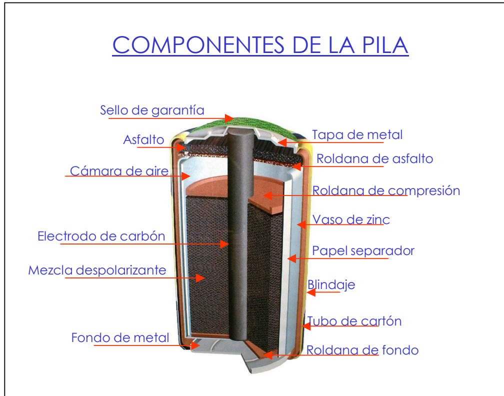
Figura 3. Partes que conforman la pila zinc carbón.
