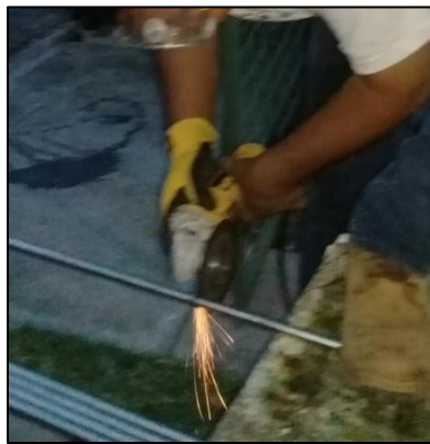
Figura 1. Corte de tubo de acero inoxidable ASTM A270 SS304
