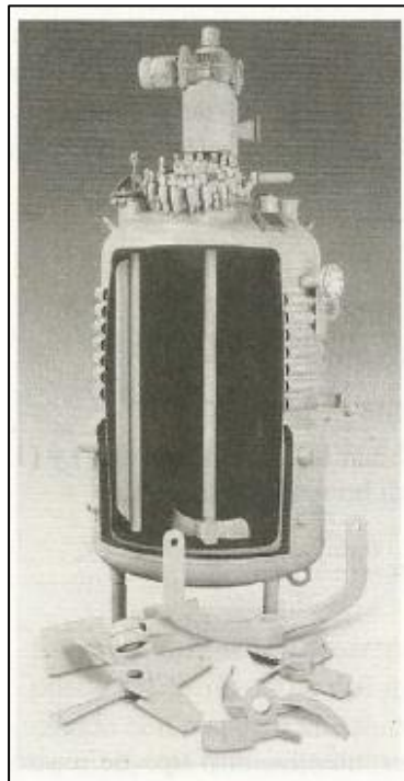
Figura 3. Esquema de un reactor CSTR.
