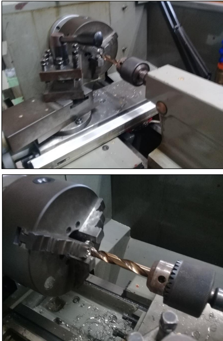
Figura 3. Mecanizado de la pieza para sostener el tubo del reactor en el enchaquetamiento
