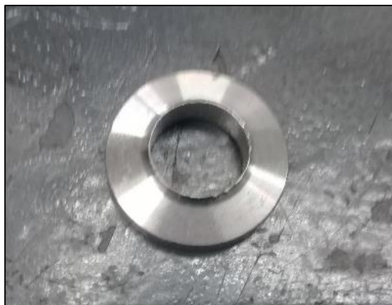
Figura 5. Férrula después del mecanizado
