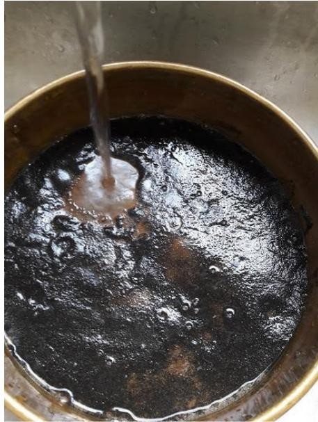
**Preparación del ensayo de reactividad potencial**
