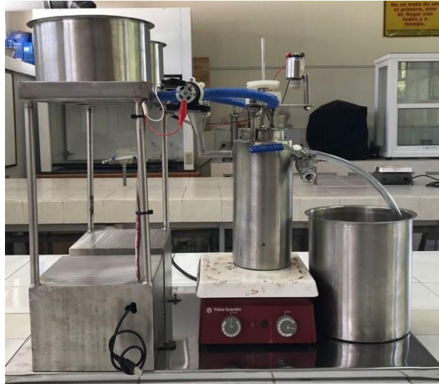
Figura 14. Vista de la elevación frontal, módulo del reactor
