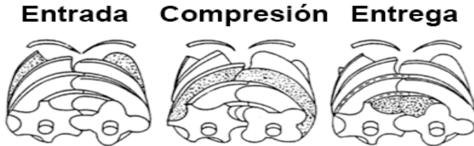
Figura 3. Movimiento del aire durante compresión.
