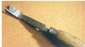
Con el gouger, una especie de formón de carpintero o escoplo curvo, se perforaba antiguamente un túnel en la suela para poder fijar la costura. Hoy en día este proceso se hace mediante una máquina que imita el método manual y gracias a la cual se acelera el proceso de producción.
