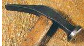
El martillo de remendón fija la piel sobre la horma de madera y la clava de forma provisional. Después la pala se cose al cerquillo y se retiran las agujas. El martillo a veces está magnetizado para facilitar el manejo de las pequeñas agujas.
