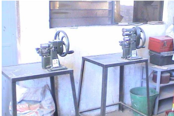
**Figura 43. Montadoras de Puntera**
