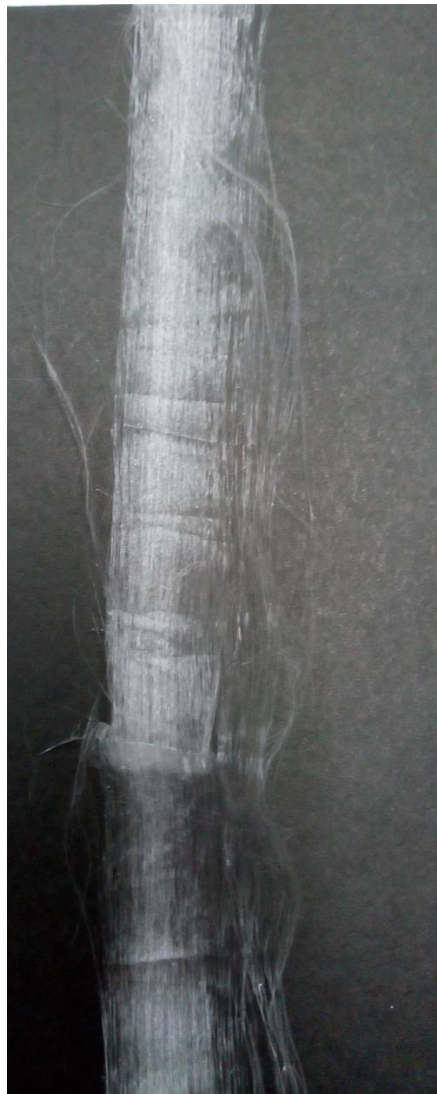
Figura 4. Fibras de poliestireno sintetizadas empleando cloroformo como disolvente
