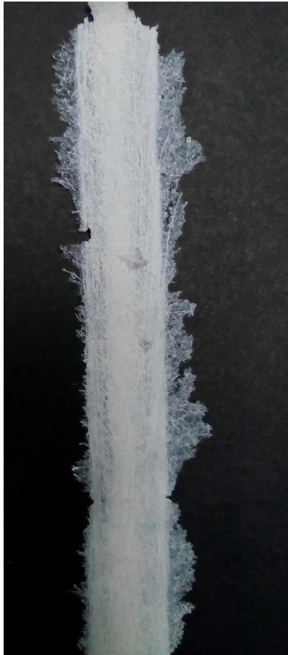
Figura 5. Fibras de poliestireno sintetizadas empleando dimetilformamida como disolvente
