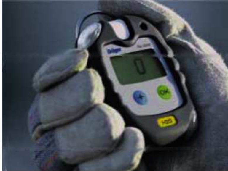
Figura 19. Detector electrónico personal de gas H 2 S.
