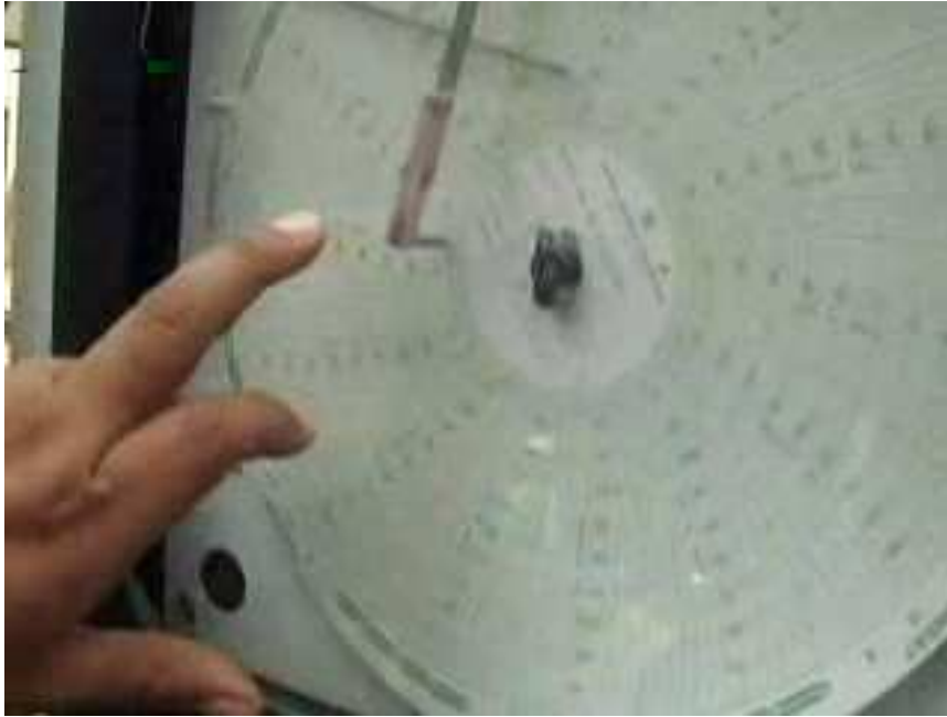
Figura 22. Carta para medir presiones en el medidor de orificio.
