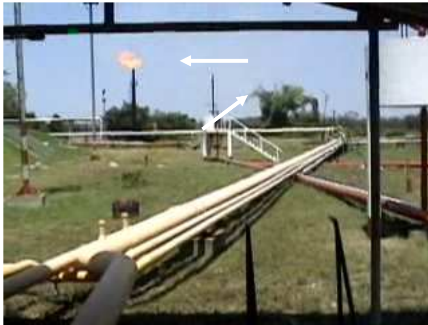
Figura 18. Quema del gas natural no tratado en la torre de quema.
