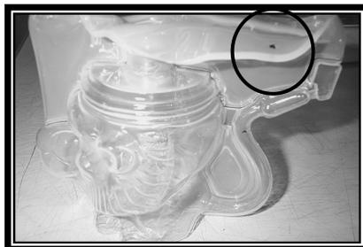
Cuando se presente este tipo de inconvenientes en el producto, como se ve en la figura 36 (sorbeto), se debe notificar al gerente de producción para verificar si el problema es por mal manejo en la materia prima o en la máquina.
