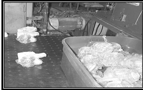
En la figura 15 se muestra el producto acumulado en la estación de trabajo, el cual debe ser inspeccionado tomando muestras al azar por el inspector de calidad, cada hora cómo mínimo antes de ser empacado.
