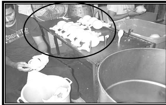
Como se observa en la figura 14 es necesario que cada producto que sale de la máquina se le de el tiempo requerido de enfriamiento, para evitar que este se deforme al ser manipulado.
