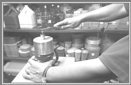
Realización de prueba de torquímetro (producto sorbito) por el inspector en turno del departamento de control de calidad.
