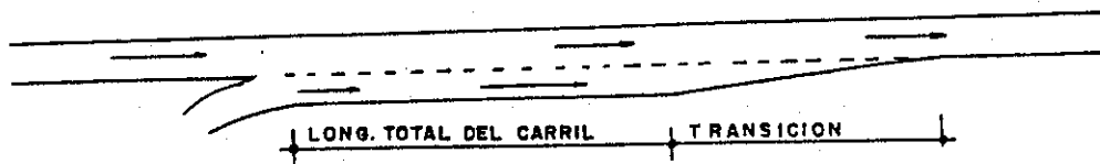
figura 2.14.b CARRIL DE ACELERACION EN TANGENTE
