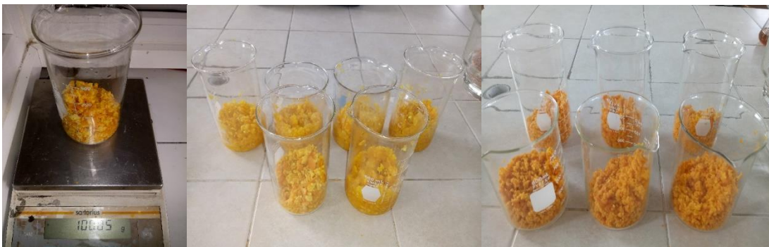
Figura A. Pretratamiento físico, disminución del tamaño de partícula para la cáscara de naranja, mandarina y limón
