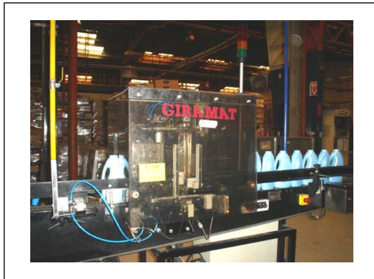
Figura 18. Orientadora de envases Giramat
