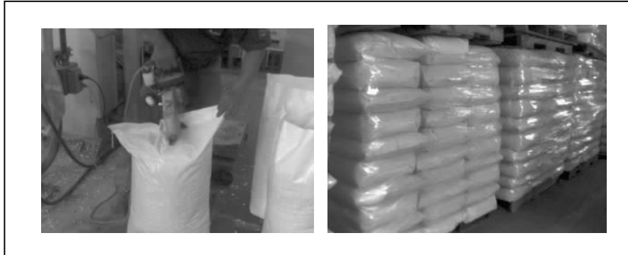
Figura 8 Colocación de sacos en tarimas
