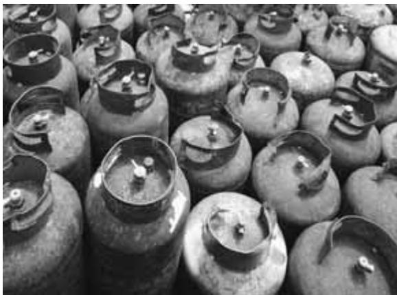
Evitar el amontonamiento de cilindros en mal estado como lo muestra la fotografía.
