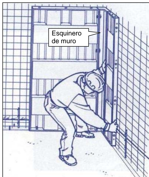
Figura 67. Colocación de esquinero de muro y formaleta
