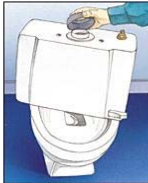
Figura 100. Instalación del tanque
