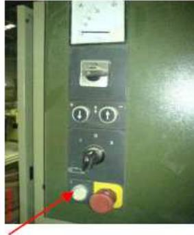
4. Una vez la maquina se encuentra en funcionamiento, se debe activar el rodillo de la lijadora dependiendo de la velocidad que sea necesaria para realizar el trabajo, esta se puede seleccionar, ya sea en velocidad lenta, poniendo el interruptor apuntado hacia el numero 1(izquierda), o en velocidad rápida, apuntando el interruptor hacia el numero 2(derecha), y si se quiere apagar el rodillo colocar el interruptor apuntando hacia el numero 0(en medio).
