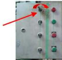
2. Seguros para ajustar las puertas a la prensa. Solamente se aflojan y se topan hasta dejar fijamente la puerta, y luego se aprietan.
