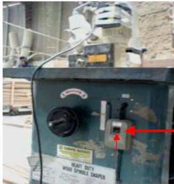
2. Una vez encendido el interruptor se debe direccionar el avanzado de los rodillos ya sea para que estos se muevan hacia adelante o hacia atrás.
