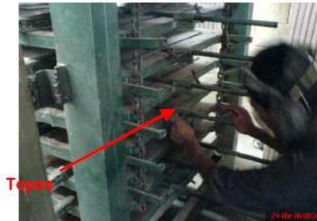
4. Una vez las puertas se encuentran bien colocadas, se debe de bajar la prensa para que esta haga presión sobre las mismas. Para hacer que la prensa empiece a bajar se debe bajar la palanca que se encuentra debajo del indicador de presión (manómetro).
