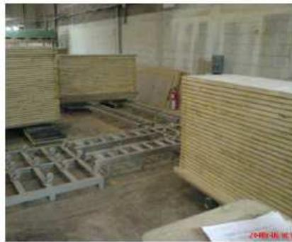
2. Toma una puerta de la percha y la coloca acostada horizontalmente en la máquina .
