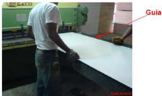
2. Cuando ya la tenga colocada en la guillotina el operador presiona el pedal para realizar el corte.
