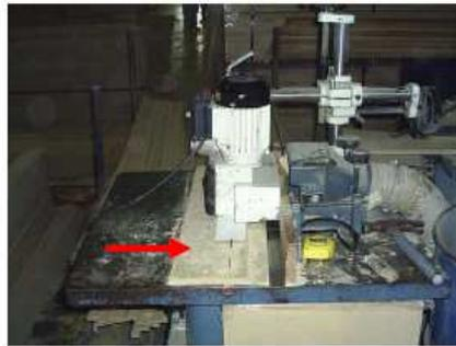
4. El siguiente paso es ajustar la máquina para los diferentes tipos de cortes, según sea necesario el caso. La máquina se debe ajustar en tres diferentes puntos moviendo las manivelas. En la parte superior, la cual hará que la maquina suba o baje. También se puede ajustar en la parte derecha, ya sea si se quiere correr hacia la derecha o hacia la izquierda. Y por ultimo se debe de ajustar el tamaño del corte, esto se debe hacer en la tuerca ubicada en la parte inferior.
