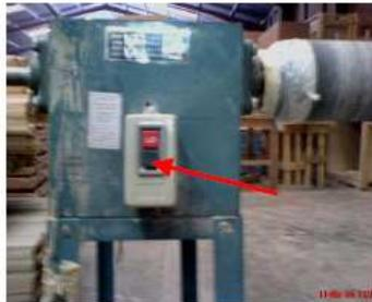
2. Para apagar la máquina, se debe presionar el botón rojo.
