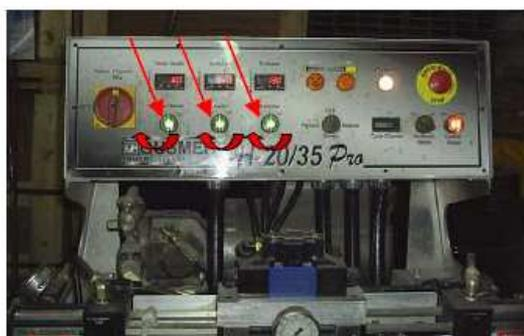
6. Para poder empezar a inyectar espuma se debe de tener en cuenta que esta debe llegar a cierta temperatura, y hasta que no lo haga no se puede inyectar. Para el calentamiento de la espuma, el primer número que se muestra debe estar en 100 grados, el segundo y tercer número mostrado deben estar en 120 grados. (Los números están mostrados en la siguiente figura con líneas rojas).
