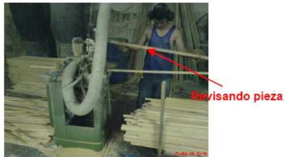
2. Introduce la pieza en la maquina conforme esta la valla jalando.
