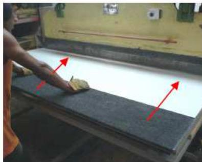
2. El operario presiona el pedal poco a poco y conforme presiona el pedal ayuda a la lamina a levantarse para realizar el doblé.
