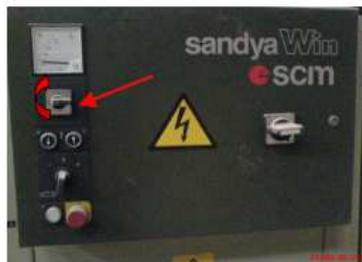
6. Para subir o bajar el rodillo se deben presionar los botones con los signos de más y menos. Al presionar el botón con la flecha hacia abajo (↓) hará que el rodillo se mueva hacia abajo y al presionar el botón con la flecha hacia arriba (↑) el rodillo subirá. Este interruptor sirve para ajustar el rodillo a la pieza que se desea lijar.
