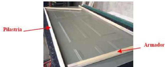
2. Se colocan 2 grapas en un lado de la unión del armador con la pilastra; el otro armador hace lo mismo solamente que en el lado contrario.
