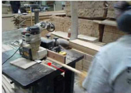
NOTA: antes de que se pasen las piezas por el trompo es necesario hacer un ajuste a la maquina dependiendo el tamaño de la pieza (esto se da a conocer en el instructivo de uso de maquinaria)
