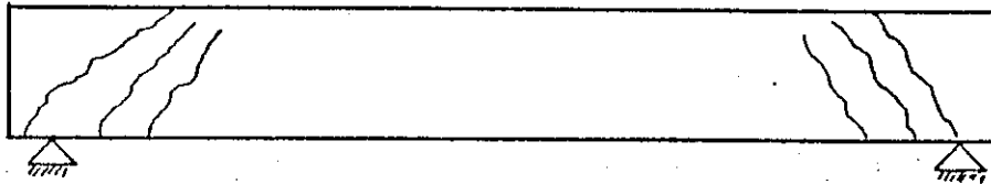
Figura No.12 Por cortante
