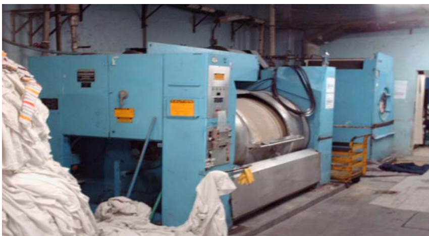
Figura 10. Lavadora de 480 lb de capacidad máxima
