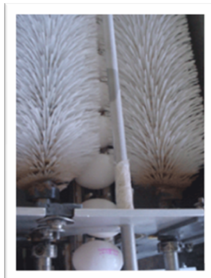
Figura 7. Limpieza del producto.
